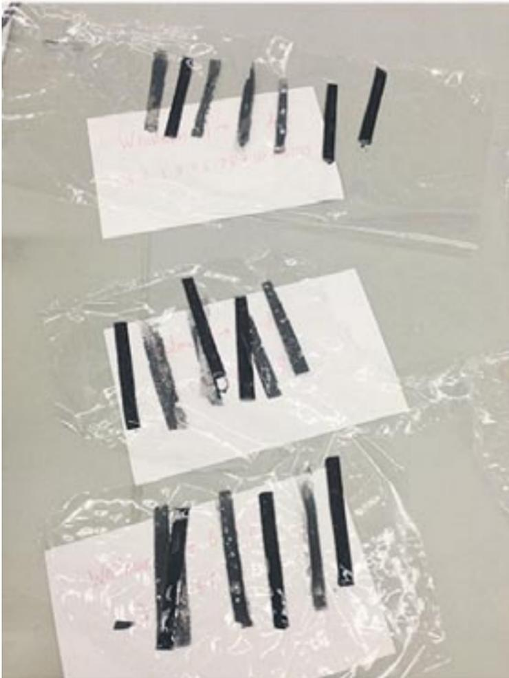
**Figura 1. Foto del biosensor de Jack Andraka. El color negro viene de los nanotubos de carbono**
